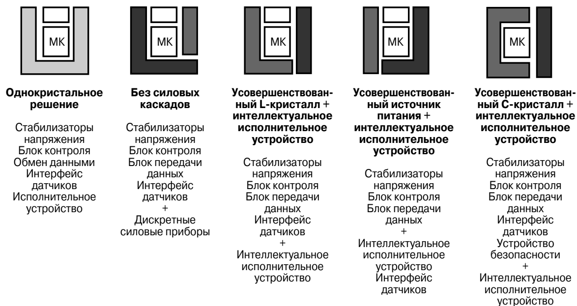
Рис. 3.94. Профессионально проведённое пользователем и изготовителем полупроводниковых приборов разбиение на функциональные блоки является необходимым условием разработки оптимальных наборов ИС.
