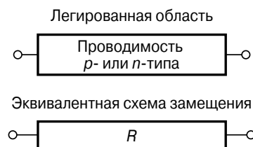
Рис. 1.3. Легированная область и её эквивалентная схема замещения.
