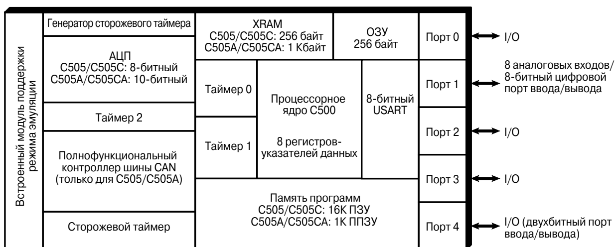
Рис. 7.16. Функциональная схема микроконтроллеров C505/C505C/C505A/C505CA.
