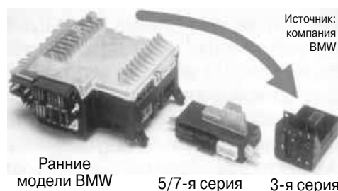
Рис. 9.1. Этапы развития контроллеров осветительного оборудования автомобиля.
