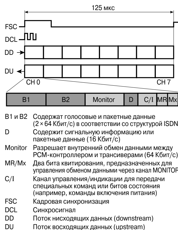
Рис. 11.4. Формат кадра при передаче данных через интерфейс IOM-2, при управлении до 8 приёмопередающими модулями с помощью одной микросхемы контроллера.
