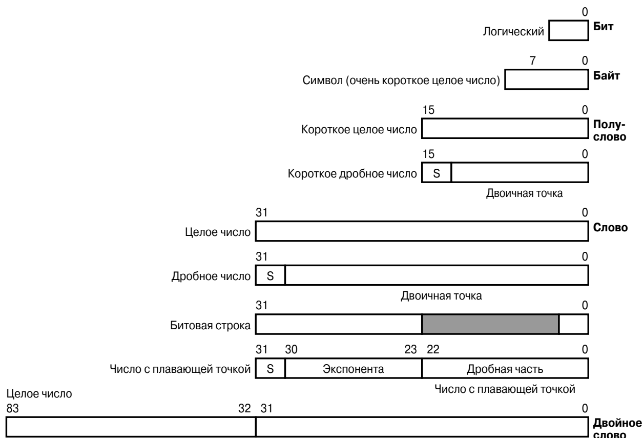
Рис. 7.38. Форматы данных, поддерживаемые микроконтроллерами семейства TriCore.
