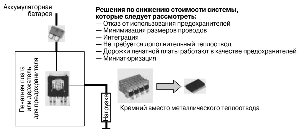
Рис. 3.64. PROFET в качестве верхнего ключа заменяет реле, имея значительно более высокую надёжность.
