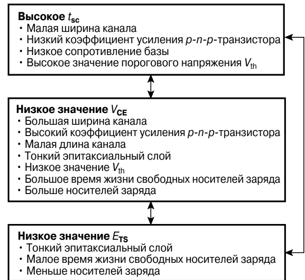
Рис. 3.164. Компромиссы при оптимизации IGBT.
