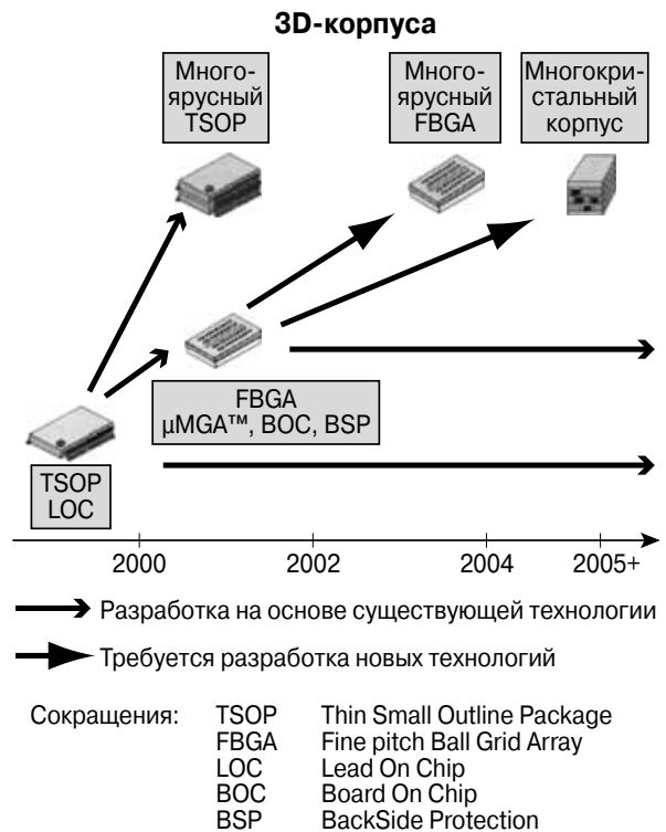
Рис. 14.9. Тенденции развития корпусов для микросхем памяти DRAM.
