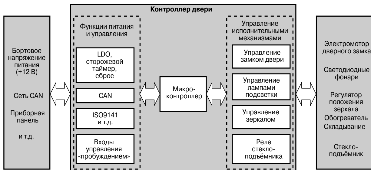
Рис. 9.5. Блок-схема контроллера двери.
