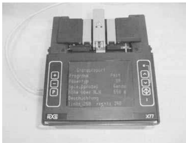
Рис. 4.27. Устройство полностью автоматизированного сращивания волокон.
