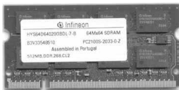
Рис. 6.18. Модули SO-DIMM, применяющиеся в переносных компьютерах. На рисунке показан модуль, объём памяти которого составляет 512 Мбайт.
