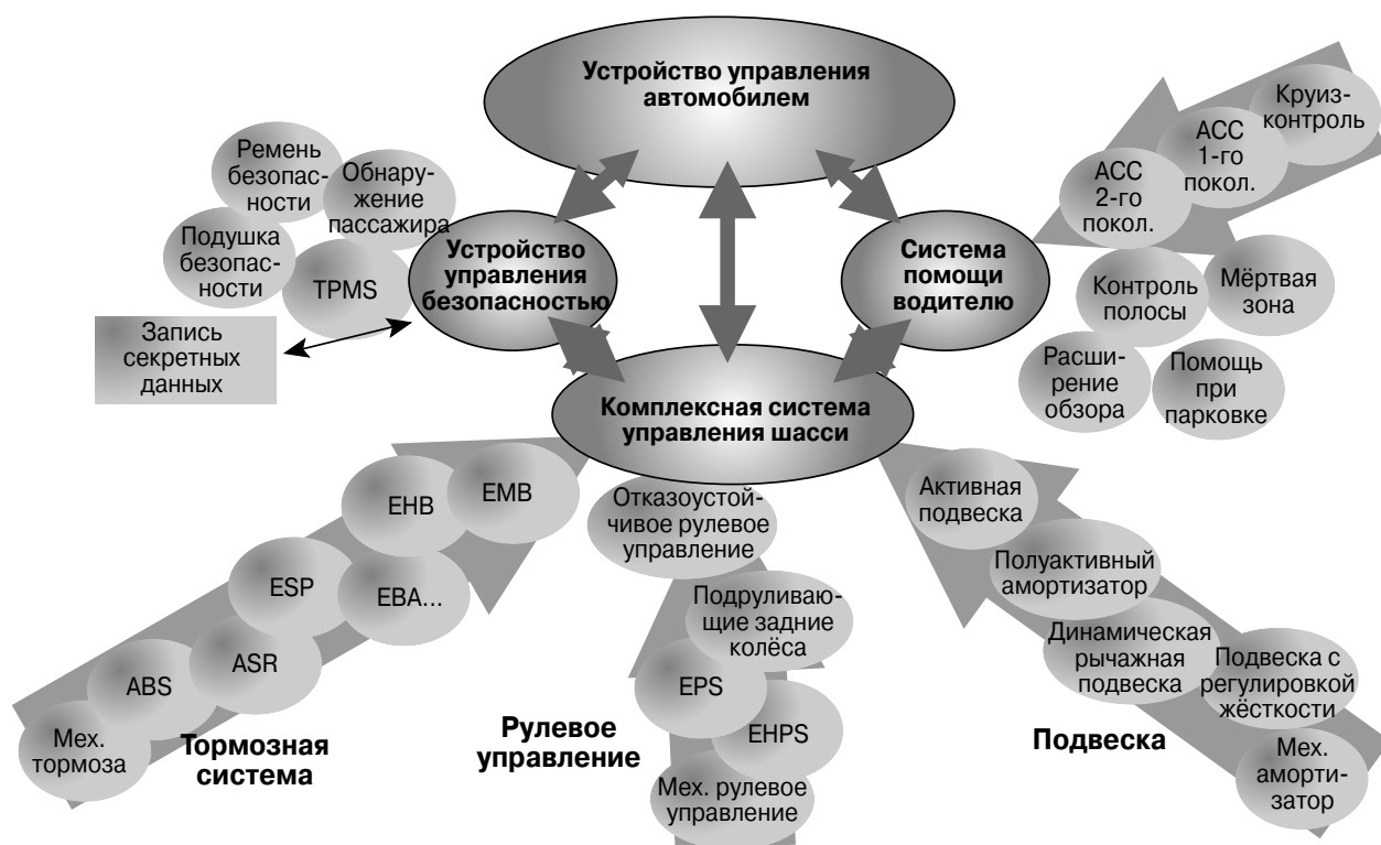
Рис. 9.19. Возможный сценарий создания комплексной системы управления шасси.
