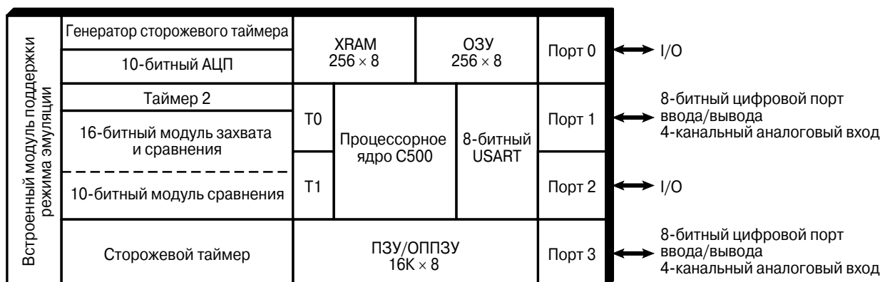
Рис. 7.15. Функциональная схема микроконтроллера C504.
